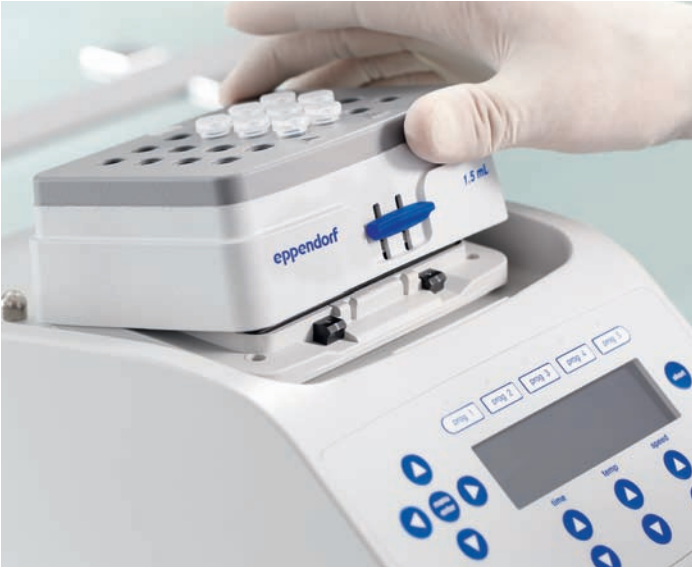
Eppendorf ThermoMixerC로부터 SmartBlock 제거
